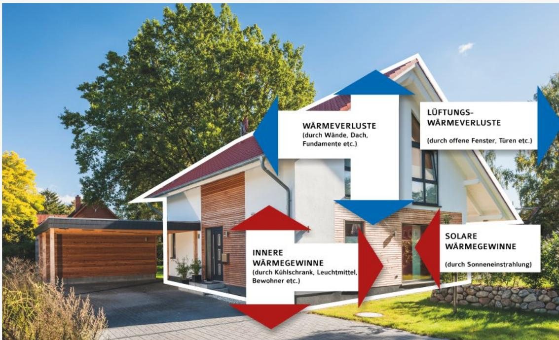
Die Wärmebilanz eines Hauses setzt sich zusammen aus Wärme, die unbeabsichtigt verloren geht und Wärme, die „passiv“, also durch Sonneneinstrahlung, die Körperwärme der Bewohner und innere Wärmequellen, wie durch den Betrieb elektrischer Geräte, gewonnen wird.
